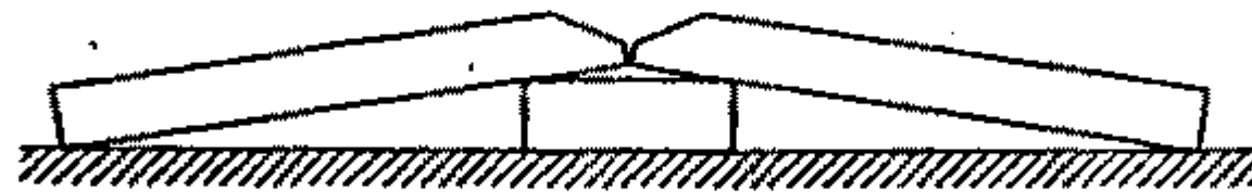
Hình 2.25. Tạo biến dạng ngược khi hàn
